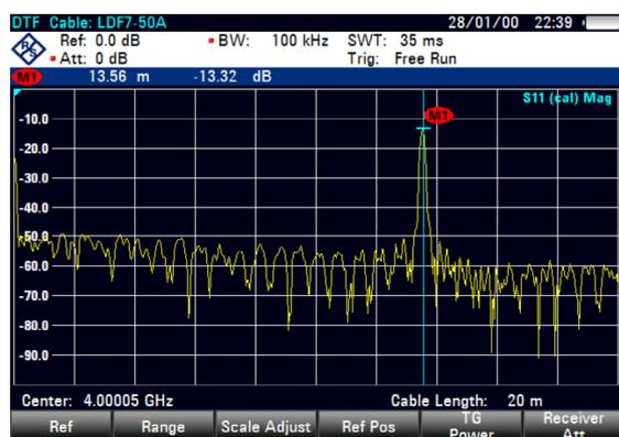
Une ligne verticale bleue représente la position du marqueur sur l'axe horizontal (p. ex. la fréquence).
