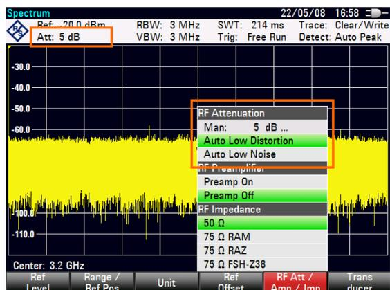
Vous pouvez également régler l'atténuation manuellement. Le R&S ZVH permet une atténuation dans la plage de 0 à 40 dB par pas de 5 dB.
