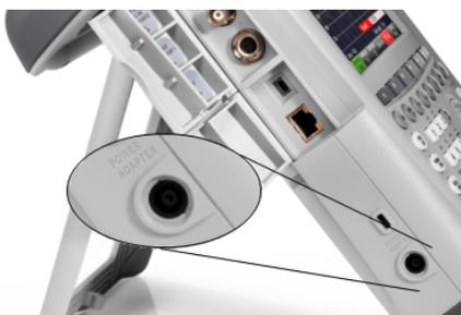
Le R&S ZVH est alimenté en courant au moyen d'un transformateur d'alimentation AC/DC par le biais du connecteur DC. Vous pouvez également utiliser le connecteur DC pour charger la batterie.
